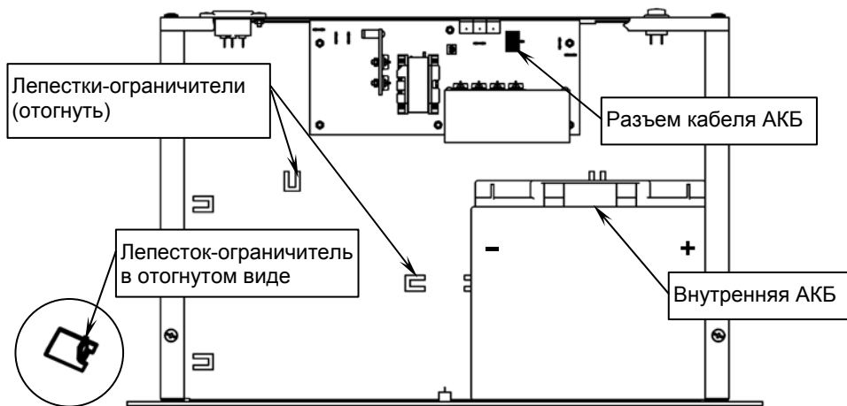
Рисунок 4 – вид источника со снятой крышкой и одной внутренней АКБ
