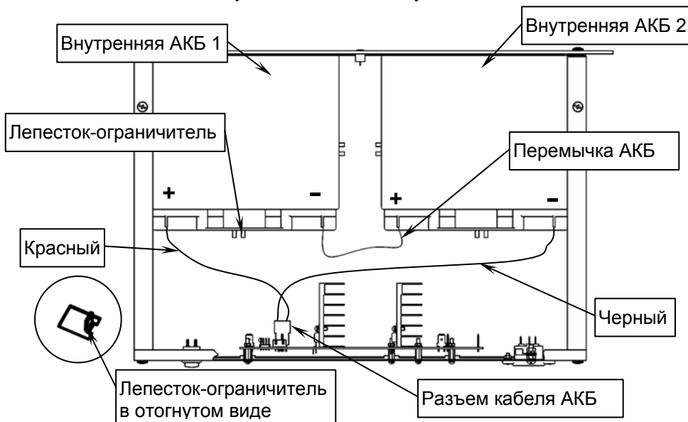
Рисунок 4 – вид источника со снятой крышкой и двумя АКБ
