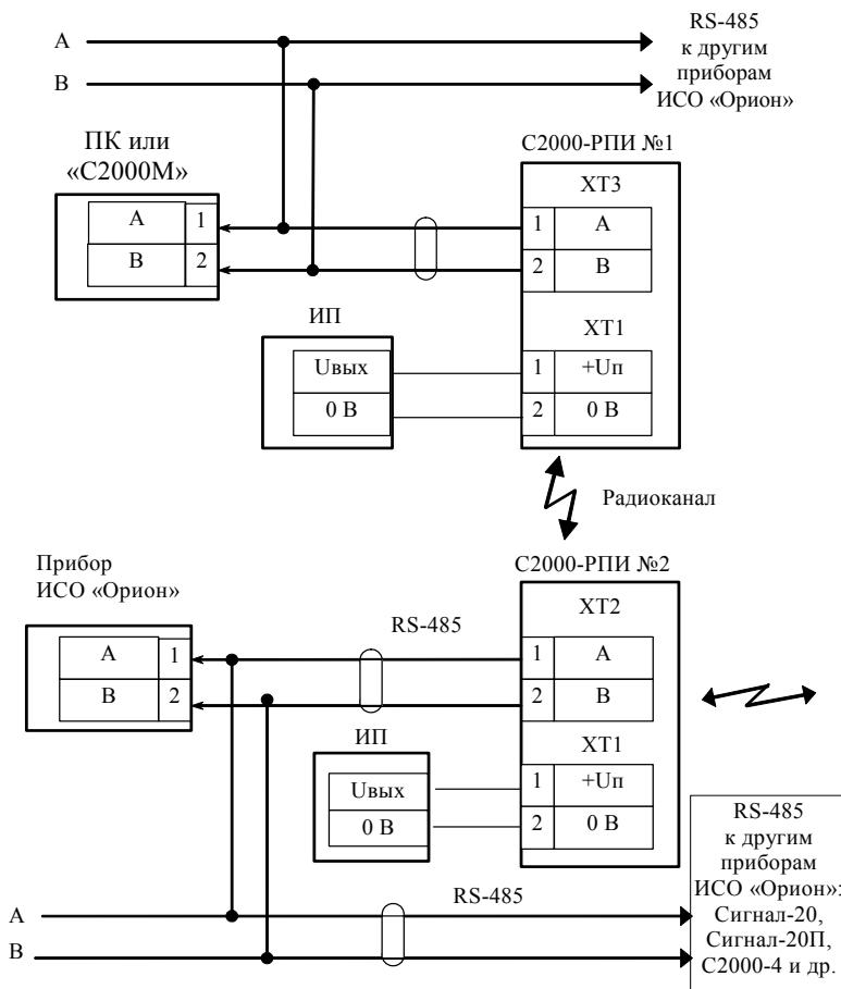
**Рисунок 7.** Вариант схемы подключения «C2000-РПИ», используя схему удлинения интерфейса RS-485 в ИСО «Орион»
