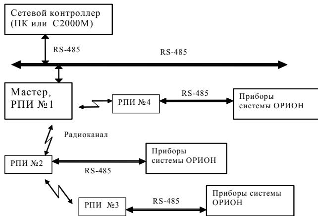
**Рисунок 4.** Пример использования РПИ для ретрансляции пакетов по радиоканалу
