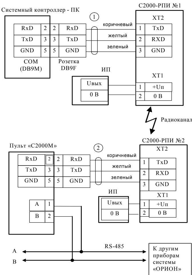
Рисунок 6. Пример использования РПИ с интерфейсом RS-232
