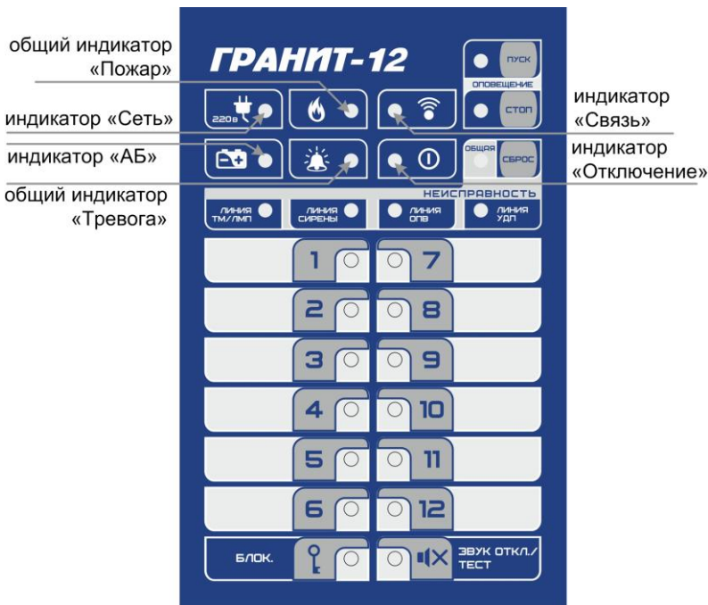
Рис.2 Панель индикации и управления прибора Гранит-12
