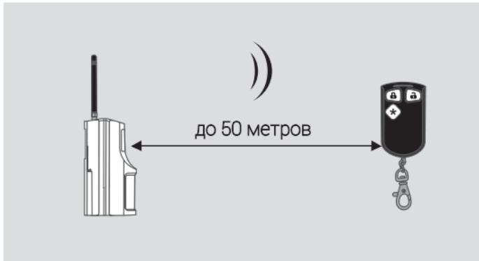
Нажмите на брелоке кнопку **«A»** на 1-2 с. Брелок мигнет желтым, красным. Сигнализатор издаст звуковой сигнал. Сирена мигнет один раз и издаст звуковой сигнал.
