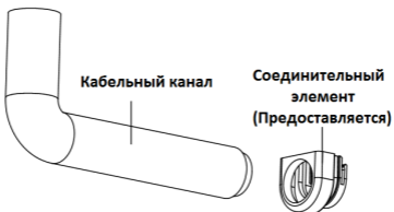
Рисунок 2-4 Подключение соединительного элемента к кабельному каналу
