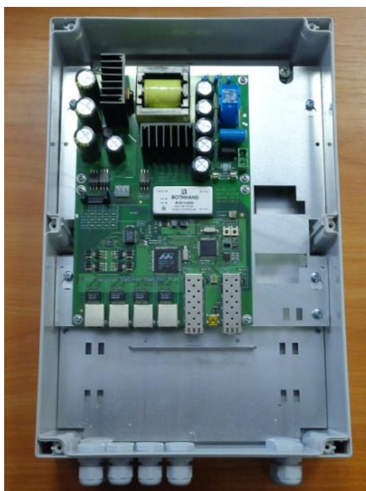
Рис. 2.1-2. PSW-2G+ - вид внутри
