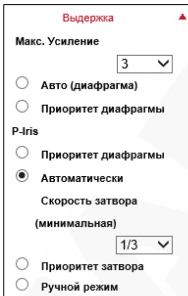
**Авто (диафрагма) Скорость затвора (минимальная) (Auto Iris):** в данном режиме в первую очередь настраивается диафрагма в автоматическом режиме, затем электронный затвор.
