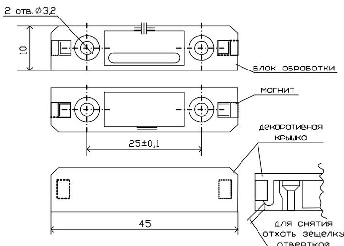
Рисунок 2 Установочные размеры
