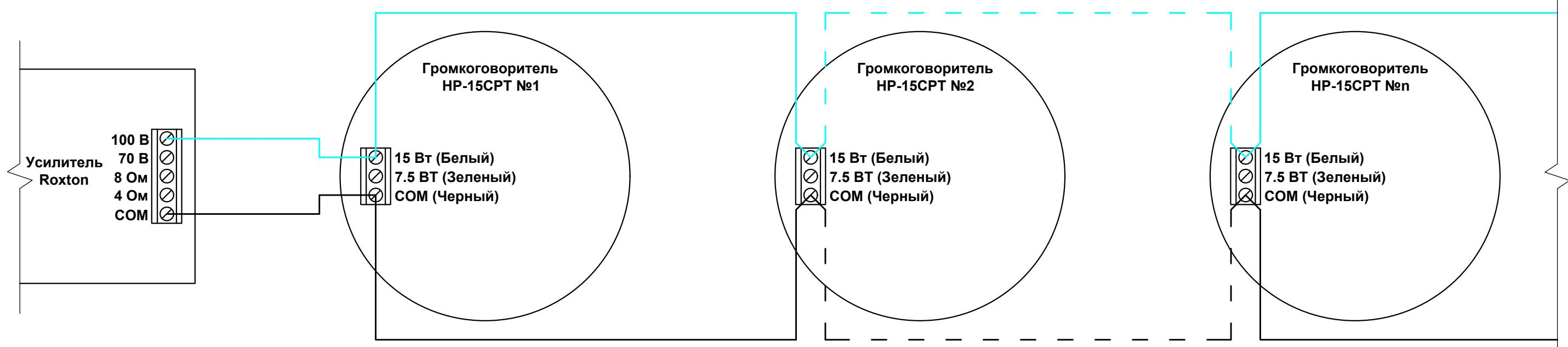
**2. Схема подключения рупорных громкоговорителей HP-15CPT к 100 В выходу усилителя на мощность 7.5 Вт**
