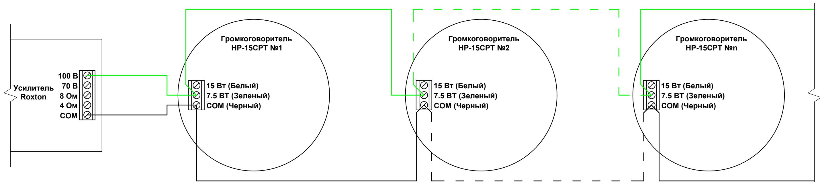
**3. Схема подключения рупорных громкоговорителей HP-15CPT к 100 В выходу усилителя на мощность 15 и 7.5 Вт (смешанное подключение)**
