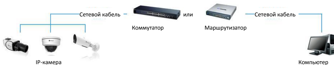
Рисунок 2-1-2 Подключение через коммутатор или маршрутизатор
