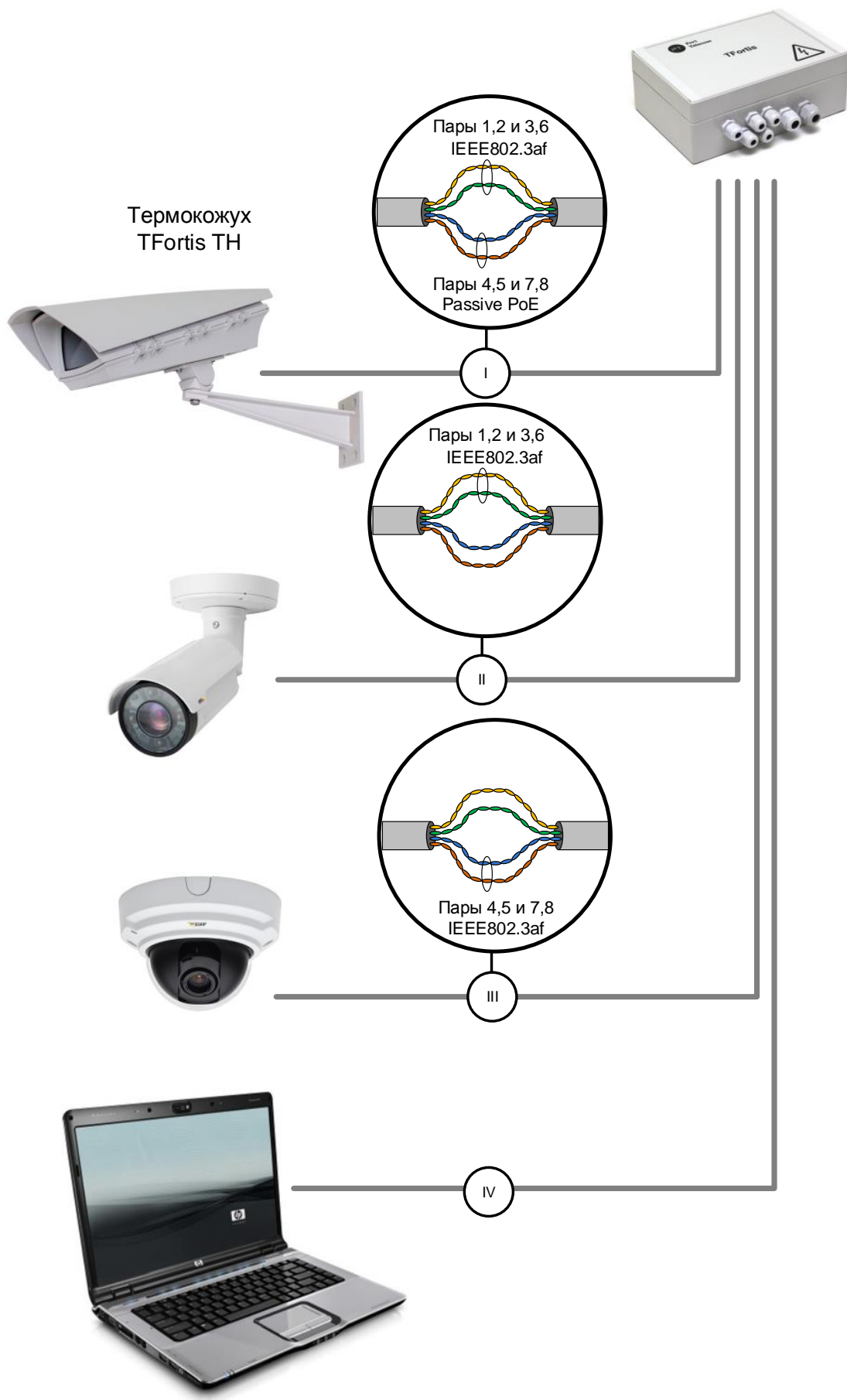
Рис. 2.3. Схема питания по PoE для разных случаев
