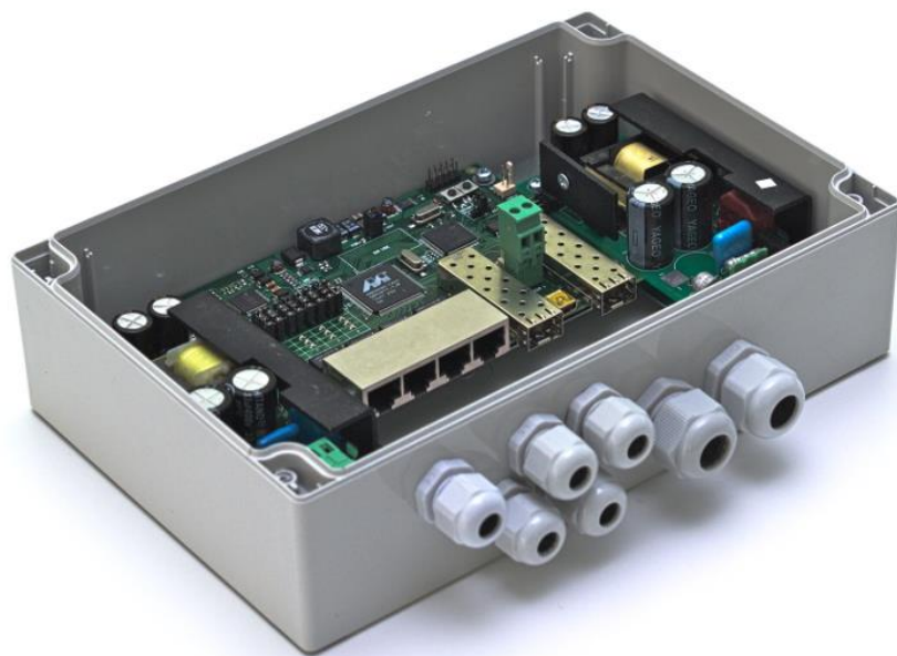
Рис. 2.1-2. PSW-2G4F - вид внутри
